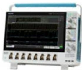
Osciloscopio pantalla táctil 12 bits,
