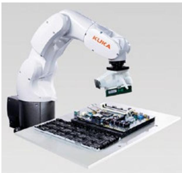
Figura 6. Los robots industriales compactos como el KUKA Agilus KR 3 están diseñados con la seguridad como una consideración importante y pueden compartir de manera segura el espacio de trabajo y colaborar con operadores humanos, si se siguen los estándares de la industria durante la configuración. (Fuente de la imagen: Kuka Robotics).
