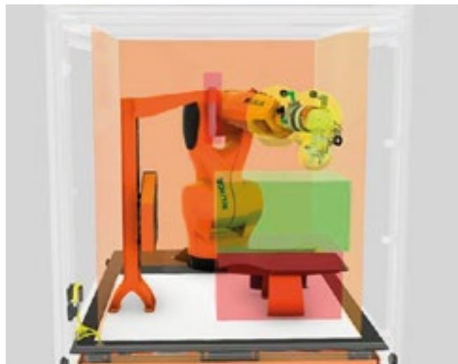
Figura 8. Los desarrolladores pueden refinar el monitoreo de seguridad relacionado con la posición usando el software SafeOperation de KUKA, con el que pueden definir un área operativa y modelar herramientas de efector final. (Fuente de la imagen: KUKA Robotics).
