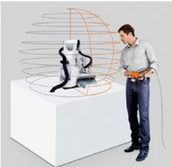
Figura 1. Los pequeños robots industriales están diseñados para operar en cooperación con humanos, en lugar de hacerlo de forma aislada. (Fuente de la imagen: KraussMaffel/KUKA Robotics).
