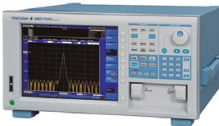
del gas acetileno para emitir una señal de calibración de longitud de onda que es precisa a 0.6 picómetros. Esta fuente también se utiliza junto con la capacidad de alineación óptica automática para compensar cualquier desviación en el eje óptico causada por las vibraciones sufridas durante los transportes y los cambios de temperatura. Combinando estas características, el AQ6377 puede mantener su alto rendimiento óp-
