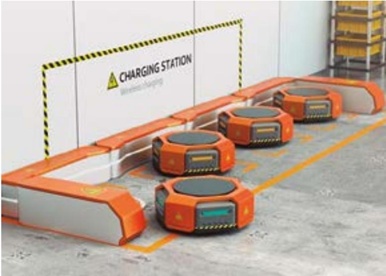
Figura 3. Vehículo de guiado automático.
