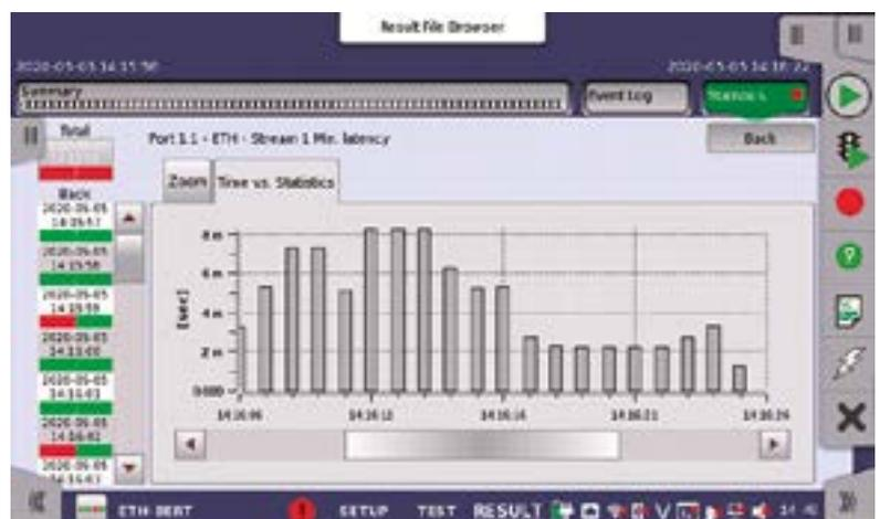
Figura 4. Medida de latencia con el MT1000A. Los valores pertenecen al rango de 1 – 9 ms y ofrecen una elevada precisión.
