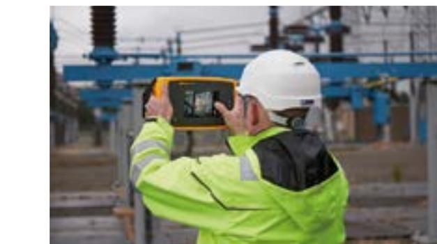
ará los datos más importantes sobre la descarga parcial, incluida la identificación del tipo de descarga parcial. La ii910 permite la grabación en vídeo de hasta 5 minutos y la batería tiene una autonomía de al menos 6 h.
