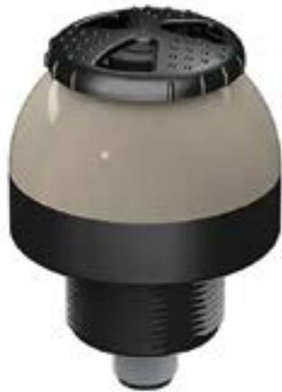
Figura 3. Las luminarias pick-to-light de la serie K50 de Banner Engineering funcionan con corriente continua, con indicación sonora constante o en staccato y con una selección de indicadores LED de 1, 2 o 3 colores, según el modelo. (Fuente de la imagen: Banner Engineering).
