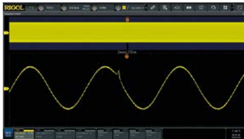
Figura 1. Alta resolución temporal de un tiempo de medida más largo a 2 Gpts y 20 GS/s.
