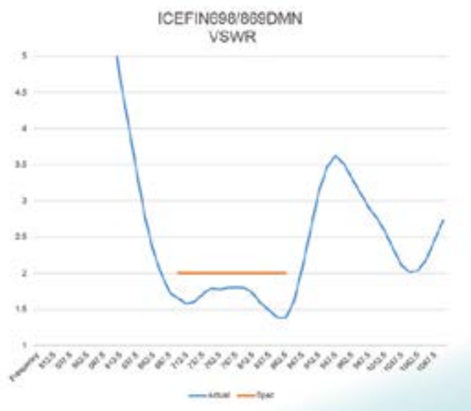
Imagen 1. Gráfico de la VSWR en una antena de perfil bajo de la serie ICEFIN de PulseLarsen (fuente: PulseLarsen).
