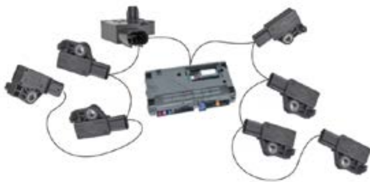
Figura 1. Una serie de sensores Molex RNC conectados en cadena.
