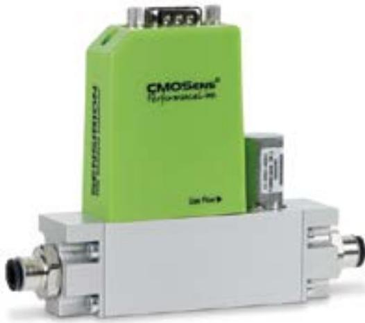
Figura 1. La familia de controladores de flujo másico Sensirion SFC5500 utiliza la tecnología microtérmica CMOSens para medir con precisión el volumen de gas a través del canal de flujo de gas, independientemente de las variaciones de temperatura o presión. (Fuente de la imagen: Sensirion)
