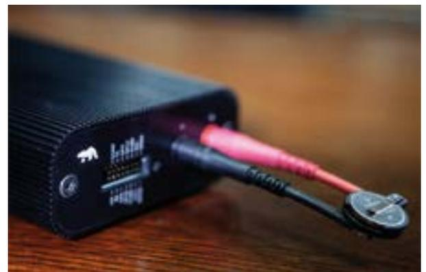
Figura 3. CR2032 conectada al Otii Arc para crear el perfil de la pila de botón (fuente: Qoitech).
