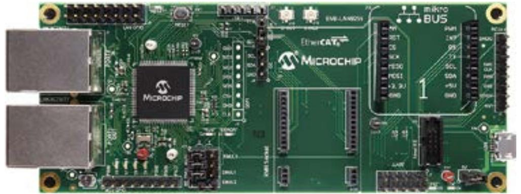
Figura 2. La placa de evaluación LAN9255 (EVB-LAN9255) permite a los ingenieros desarrollar utilizando un microcontrolador Cortex M4F integrado con un controlador de dispositivos EtherCAT.
