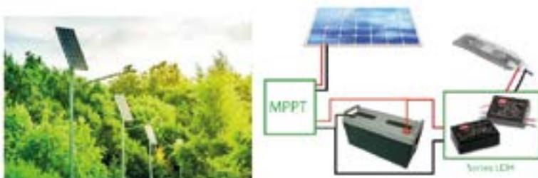
Figura 4. Estructura de farola solar.
