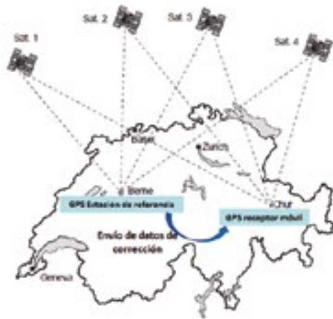
Figura 13. Principio funcionamiento DGPS con estaciones de referencia de GPS.
