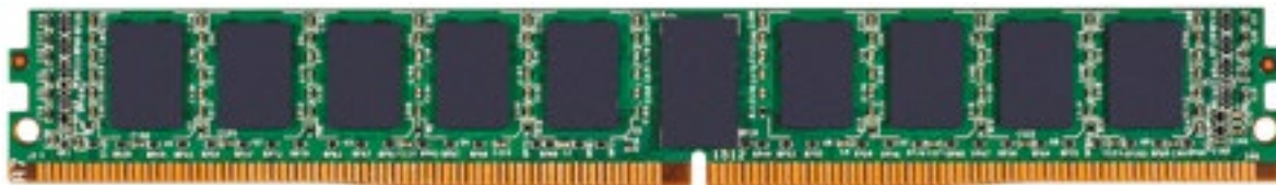
Figura 2. DIMM VLP y conectores de diverso tipo.
