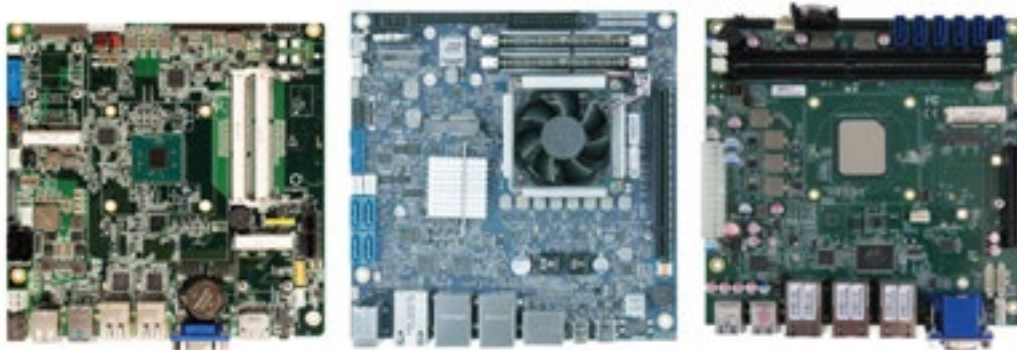
Figura 5. Ejemplos de placas principales para IIoT que utilizan módulos y pueden resistir entornos operativos adversos.
