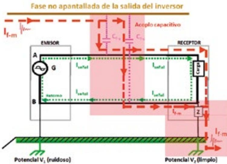
Figura 12. Corriente en MC acoplada capacitivamente a los conductores de señal. A: conductor de señal, B: conductor de retorno. G: generador de señal.  $C_{fs}$ : capacidades parásitas entre la fase y los conductores de señal y su retorno.
