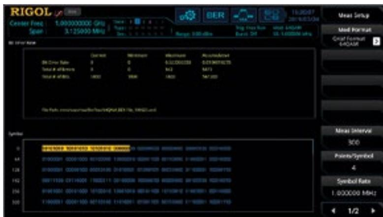
Figura 8. Medición de la tasa de error de bits de una señal 64QAM.
