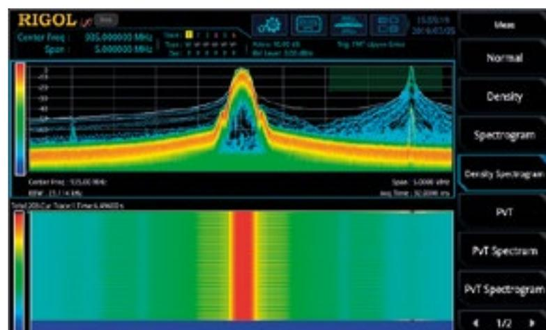
Figura 14. Medición de una señal de interferencia no deseada con un transmisor GSM.
