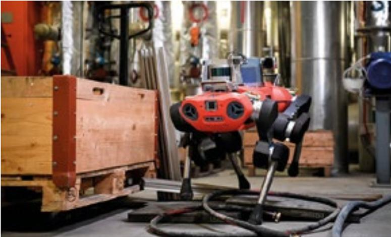
Figura 1. El ANYmal C de ANYbotics es un robot robusto que está diseñado para trabajar en los mismos entornos que los humanos. Esto incluye terrenos exigentes y escabrosos como parques eólicos marinos, plataformas petrolíferas, minas e instalaciones industriales con muchos obstáculos en el camino.
