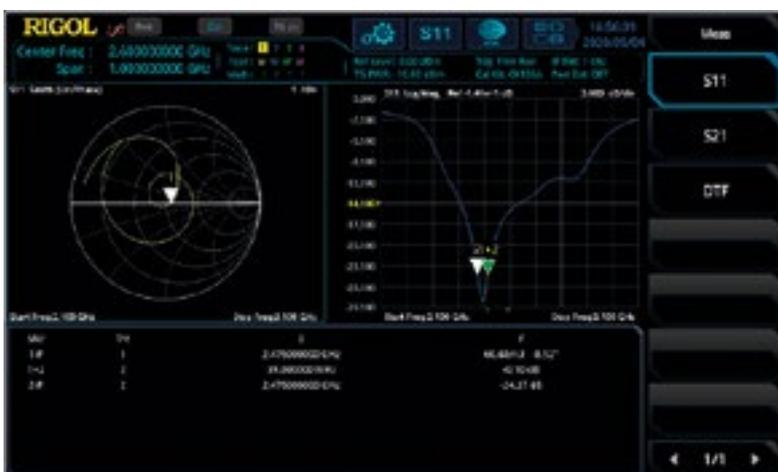
Figura 9. Medición de la reflexión del filtro [S11] con la serie RSA5000N.
