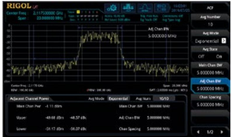
Figura 10. Medición de canal adyacente de una señal W-CDMA (UMTS).
