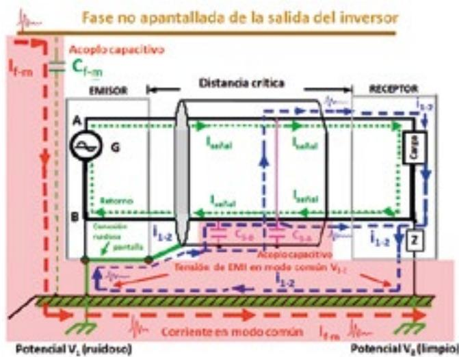
Figura 14. Acoplamiento de ruido: conexión de la pantalla en el emisor. A: conductor de señal, B: conductor de retorno, G: generador de señal.  $C_{s-B}$  y  $C_{s-A}$ : capacidades parásitas pantalla – conductores de señal.
