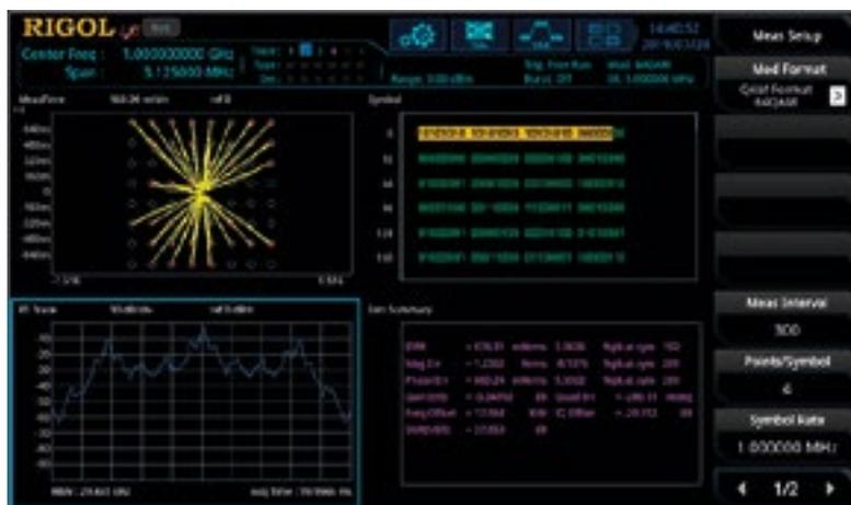
Figura 6. Medición de un transmisor de RF con el modo RSA5000N VSA: vista de constelación, medición de errores, visualización de frecuencia (tiempo real) y visualización de los símbolos decodificados.
