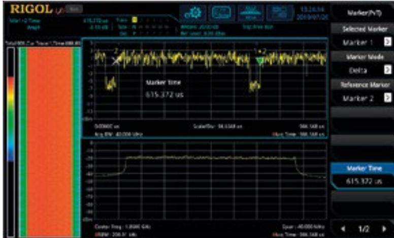
Figura 15. Medición en el dominio del tiempo (arriba) y medición de frecuencia (abajo), así como el espectrograma (izquierda) de una señal de RF modulada de un transmisor.
