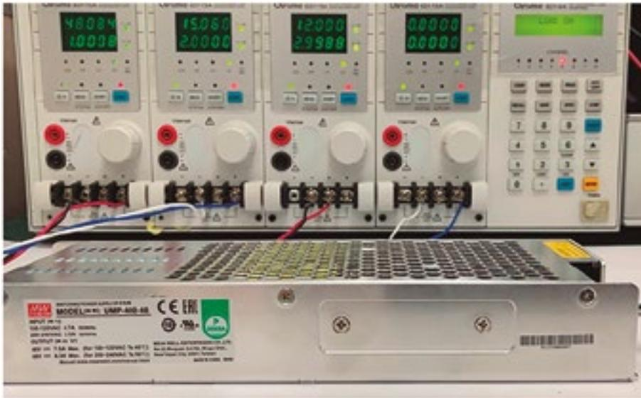
Figura 2. UMP-400-48KJ\_Pruera de Voltaje.
