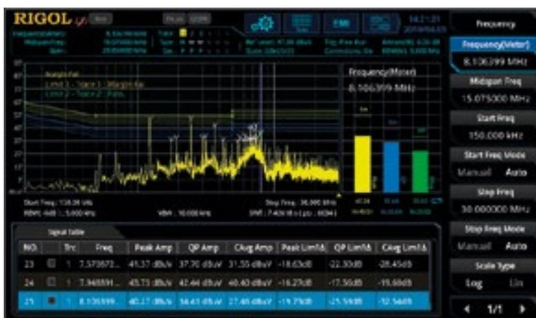
Figura 16. Vista de la medición de EMI con la traza, los metros (lado derecho) y la tabla de señales (abajo) con resultados.
