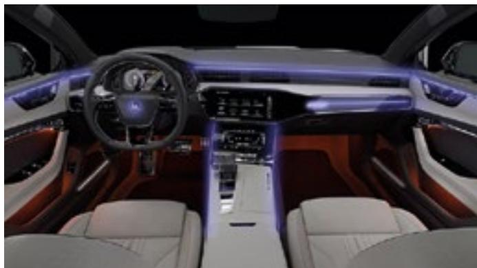
permite una precisión de mezcla de colores con un delta UV del 1% para garantizar que no haya diferencias distinguibles entre los LED individuales en la barra de luces. Además, la alta resolución inteligente para la deriva del color relacionada con la temperatura ayuda a mantener una experiencia del usuario constante y sin distracciones en todas las condiciones de funcionamiento.
