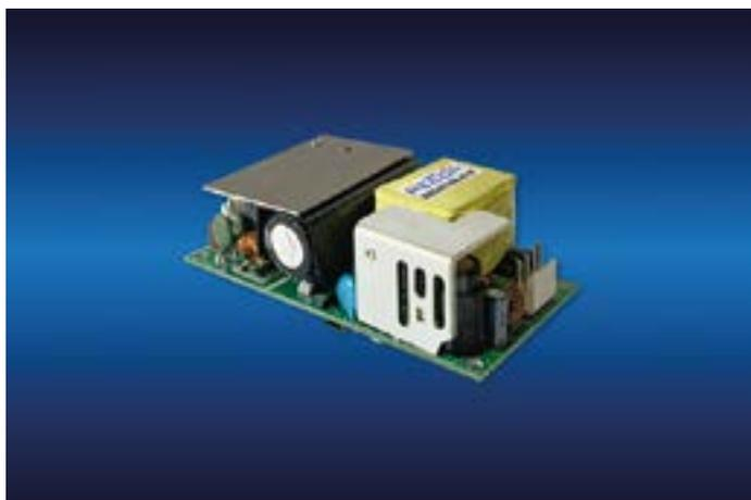
Las piezas operan de 85 a 264VCA con salidas individuales estrictamente reguladas que incluyen 12V, 15V, 24V, 36V y 48VCC y proporcionan una potencia de salida de 130W pico, o de forma continua con flujo de aire.
