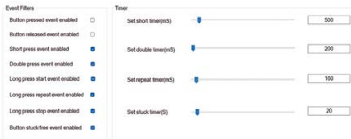
Figura 6. Captura de las opciones de configuración para las IT1 en el software DLC-02 (Meanwell).
