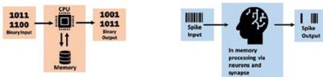
Figura 2. Arquitectura de Von Neumann vs arquitectura neuromórfica (no-Von Neumann).
