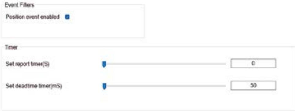
Figura 7. Captura de las opciones de configuración para una IT2 del tipo Touchpanel Slider en el software DLC-02 (Meanwell).
