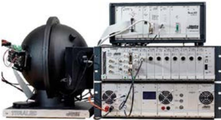
Estación de pruebas T3STER y TERALED.
