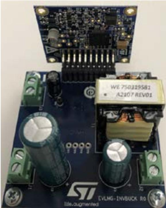
Figura 3. Ejemplo de demostración de reductor inverso con MASTER-GaN4. (Fuente de la imagen: STMicroelectronics).
