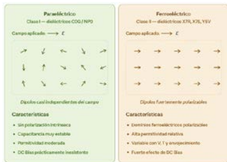
Figura 3. Diferencia microscópica entre dieléctricos paraeléctricos y ferroeléctricos.
