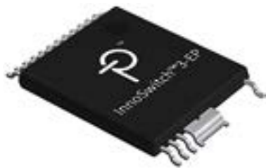
Figura 2. La familia de CI de conmutadores InnoSwitch3-EP tiene un rango de potencia de salida que depende de la tensión de entrada. Con un esquema similar al de los CI InnoSwitch3-CP, disponen de una resistencia opcional de detección de corriente en el lado secundario. (Fuente de la imagen: Power Innovations).
