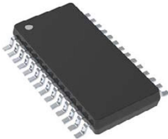
Figura 2: Interfaz LPC del Módulo de Plataforma Confiable (TPM) AT97SC3204-U2A1A-20 de Microchip Technology con un acelerador criptográfico capaz de calcular una firma RSA de 2048 bits en 200 ms.
