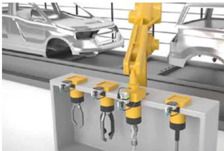
Figura 4. Posible uso de NearFi en una estación de cambio de herramientas robotizada. (Fuente de la imagen: Phoenix Contact).
