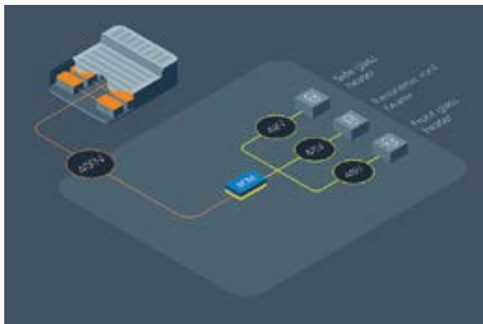
Figura 2. El BCM de Vicor funciona como transformador CC/CC. Un convertidor de proporción fija reacciona a las variaciones de potencia a una velocidad de 80 A/s. Betterfrost utiliza pulsos de energía para fundir una capa interfacial de hielo muy fina en menos de un minuto (su récord es 42 segundos) frente a los 25 minutos que necesitan los sistemas de climatización tradicionales. Esta tecnología utiliza un algoritmo propietario para fundir el hielo de manera uniforme y consume 20 veces menos energía.
