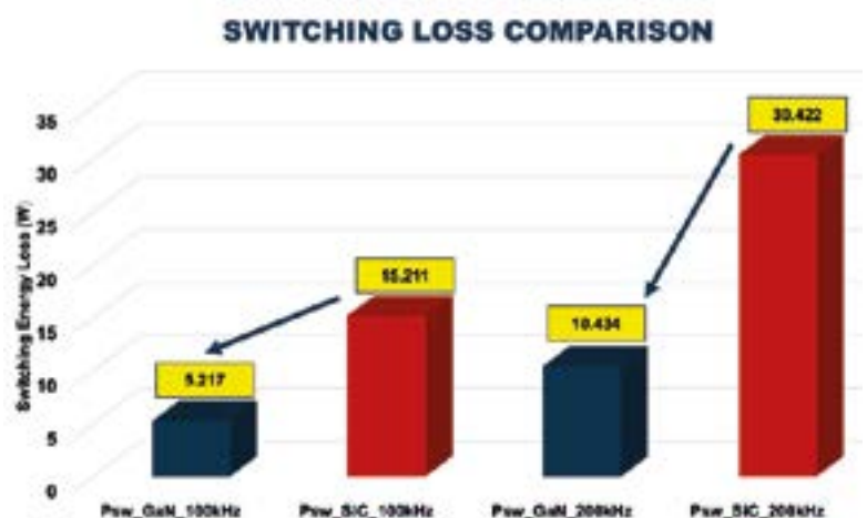
Figura 1. Comparación entre las pérdidas de conmutación del GS66508T y el C3M0065090J para 400V/15A.
