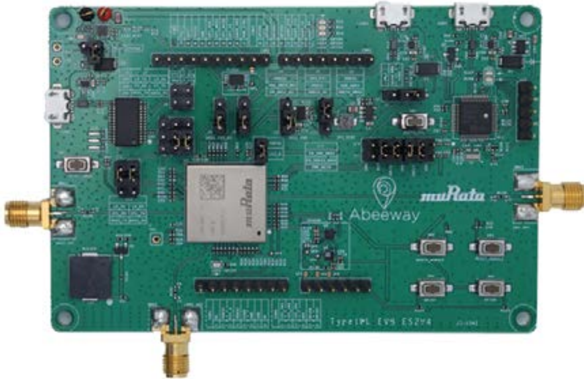
Figura 4. Kit de evaluación del módulo Type 1WL. (Fuente: Murata).
