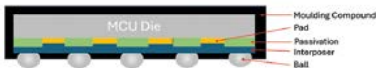
Figura 1. Estructura interna simplificada del encapsulado WLCSP.
