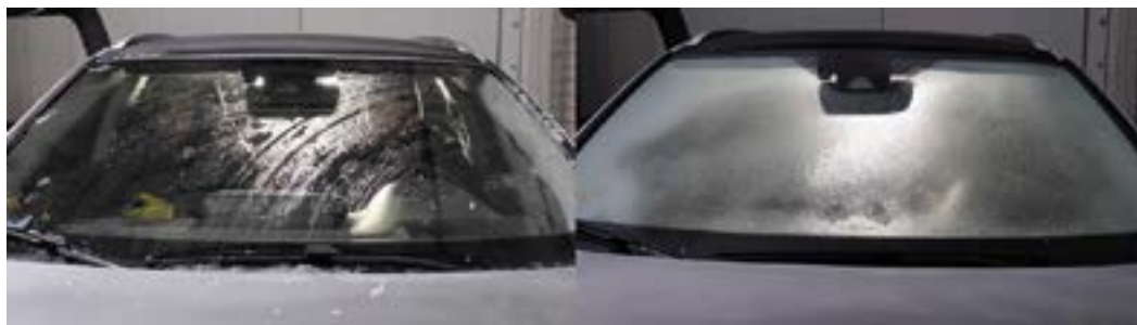
Figura 1. La revolucionaria tecnología de Betterfrost utiliza pulsos eléctricos y módulos de potencia de alta densidad para fundir el hielo acumulado en el cristal del automóvil en menos de 60 segundos consumiendo 20 veces menos energía.
