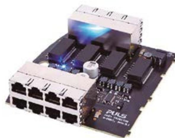
Figura 4. Inyector de alimentación por Ethernet (PoE): vista interior.
