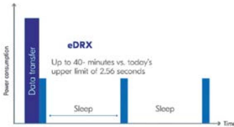
Figura 4. El módem del SiP nRF9160 soporta una recepción discontinua extendida, lo que permite a los dispositivos conseguir un ahorro drástico de energía al estar inactivo durante un período de tiempo negociado con la red celular. (Fuente de la imagen: Nordic Semiconductor).
