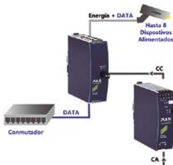
Figura 3. La combinación de un inyector PoE y una fuente de alimentación externa de 240W (CP10.481) es la alternativa a la solución todo en uno.
