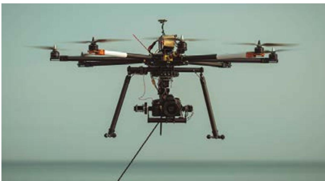
Figura 6. La mayor tensión disminuye el peso del cableado y permite que los drones cautivos alcancen una mayor altitud.
