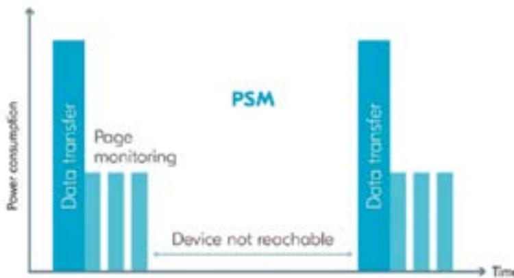
Figura 5. El protocolo PSM celular permite que los dispositivos aprovechen los modos de suspensión de baja potencia sin incurrir en los costos de energía de la reconexión, negociando períodos específicos en los que no se pueden alcanzar. (Fuente de la imagen: Nordic Semiconductor).
