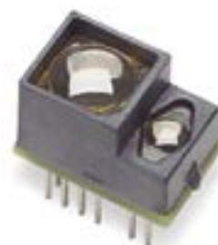
Este módulo ToF de alto rendimiento integra una fuente de luz láser infrarroja y una fuente de reloj interna. Requiere una tensión de alimentación de 5 V, mientras los datos se transfieren vía SPI usando niveles CMOS de 3,3 V estándares. Para la monitorización del estado de sistema, se emplea un píxel de referencia junto con los sensores de tensión y temperatura integrados.
