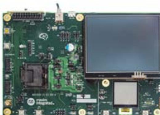
Figura 2. El kit de evaluación MAX7800 de Maxim contiene el SoC MAX78000, una pantalla táctil en color, un micrófono y un giroscopio/aceelerómetro (fuente: Maxim Integrated).
