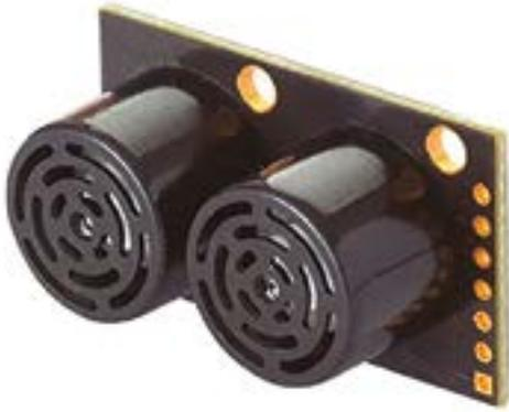
Figura 7. El MB1634-000 es un conjunto de telémetro ultrasónico con transductores de emisión y recepción y un alcance de 5 m. (Fuente de la imagen: MaxBotix Inc.).
