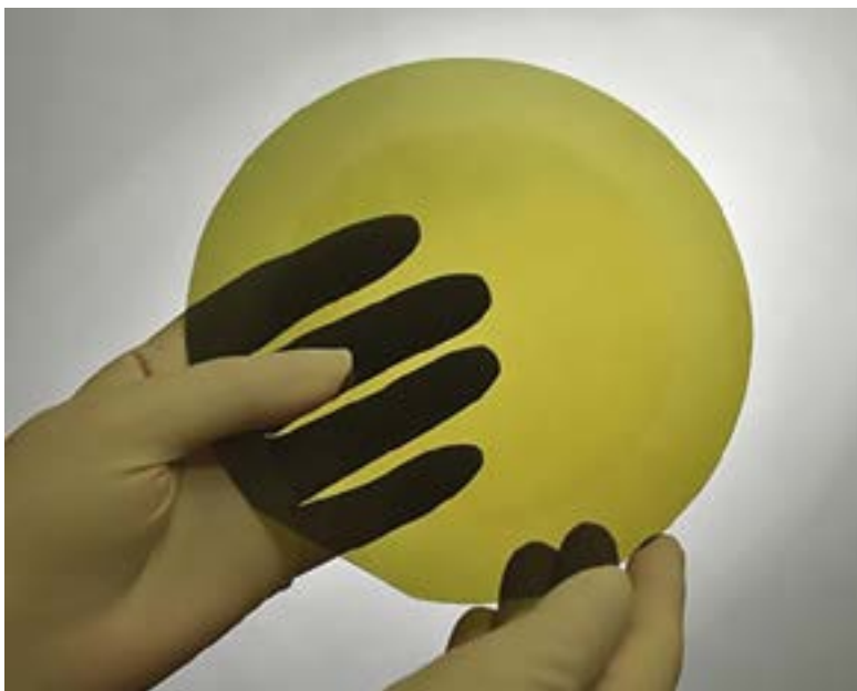
Figura 3. Capa de una oblea epitaxial de SiC.
