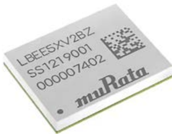
Figura 1. El LBEE5XV2BZ-883 totalmente protegido es un módulo transceptor combinado para Wi-Fi y Bluetooth que simplifica la implementación de la conectividad inalámbrica. (Fuente de la imagen: Murata Electronics).
