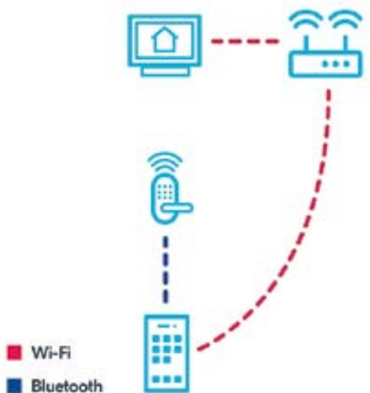
Figura 2. Bluetooth LE se utiliza para la implementación de dispositivos Matter pero no para la transferencia de datos por la red.
