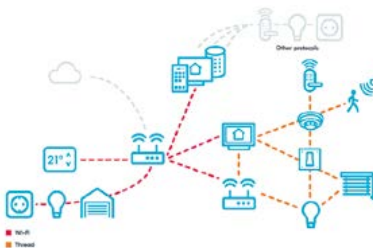
Figura 5. Matter permite que las redes Thread y Wi-Fi funcionen juntas en armonía.
