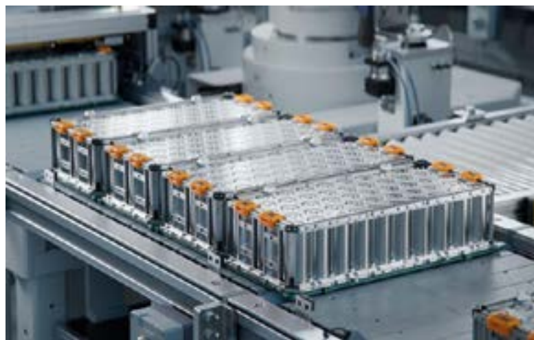
Figura 2. Una batería de iones de litio durante su fabricación (fuente: IM Imagery/stock.adobe.com).
