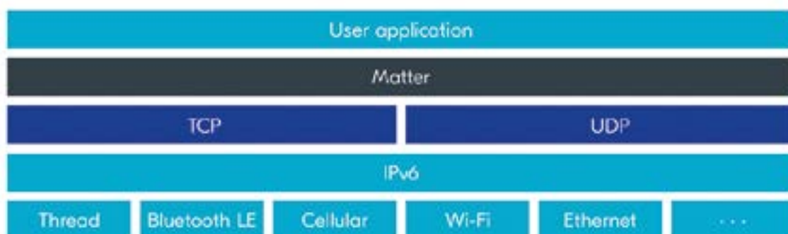
Figura 1. Matter proporciona una capa de aplicación estándar destinada a un conjunto de protocolos inalámbricos. Matter es compatible inicialmente con Bluetooth LE, Thread, Wi-Fi y Ethernet. Entre sus planes futuros se encuentra la compatibilidad con otras tecnologías interoperables con IP como IoT celular.
