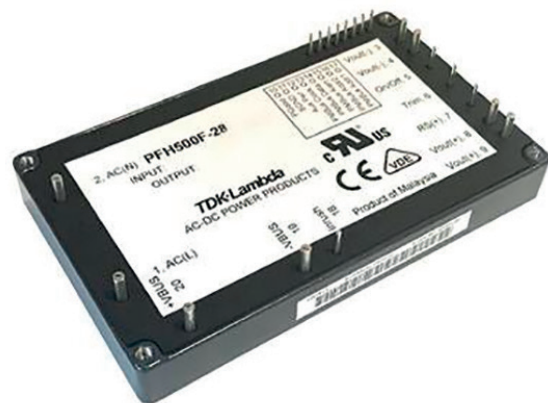
Figura 2. La serie PFH500F de convertidores de potencia CA-CC viene en un factor de forma de ladrillo 3/4 y puede entregar 500 W con una salida regulada de 28 voltios. (Fuente de la imagen: TDK-Lambda).
