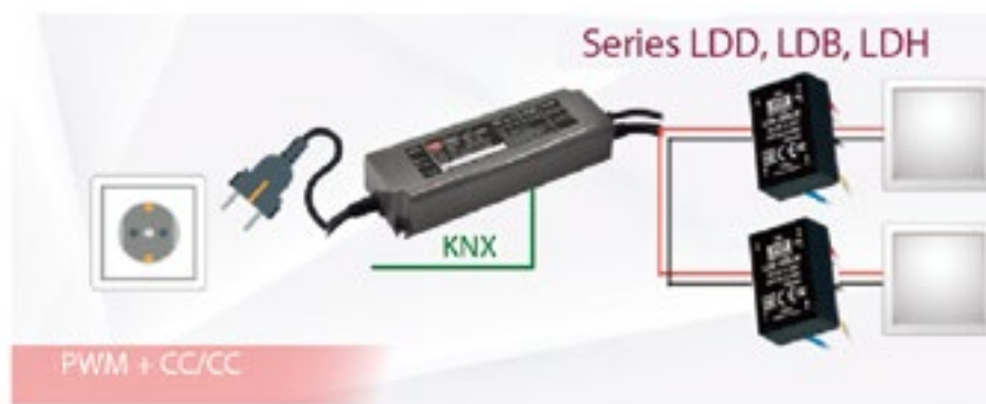
Figura 7. Driver KNX para uso con paneles LED de corriente constante + Convertidor CC/CC.
