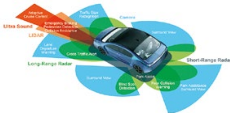
Figura 1. En los coches inteligentes, los sensores (radar/lidar, imagen, tiempo de vuelo, etc.) permiten disponer de aplicaciones como frenado de emergencia, cámaras de visión y sistemas anticollisión.
