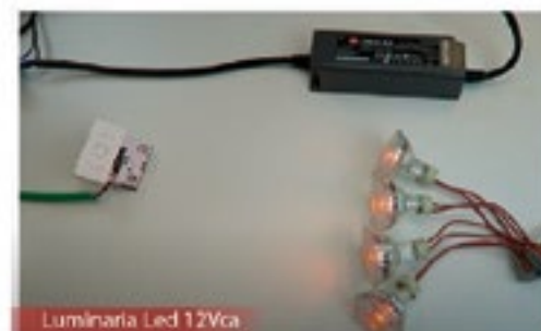
Figura 5. Método tradicional: LED de 12Vca (izquierda); Método de conducción directa KNX (derecha).
