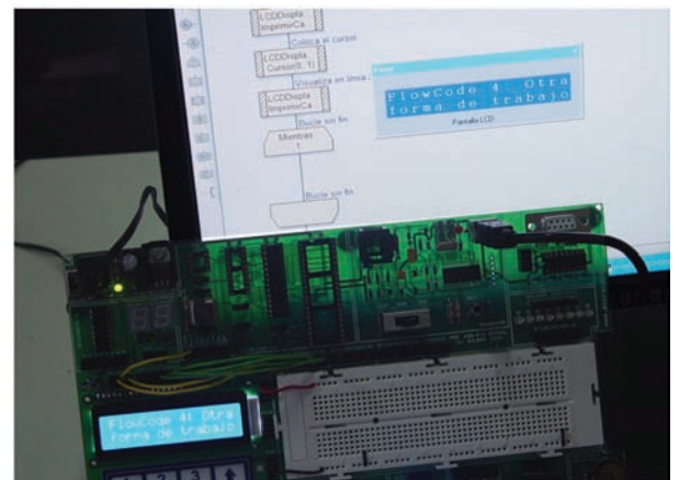
Figura 57. Ejecución del Ejemplo 4 sobre el laboratorio USB-PIC'School
