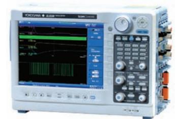
El nuevo equipo ha duplicado la memoria de adquisición (hasta 2 GMuestras), ha cuadruplicado la capacidad de su disco duro (160 GB), que permite la grabación de medidas en tiempo real (a diferencia de un Osciloscopio convencional, en el que sólo se pueden grabar formas de onda a posteriori, y con una duración en tiempo muy limitada), se le han añadido nuevas interfaces y puertos (a los GP-IB, VGA, Ethernet y USB se suman ahora la posibilidad de interfaz IRIG y puertos SD y eSATA).
