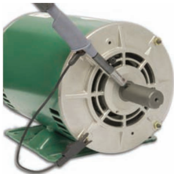
Figura 2. Medición de la tensión del eje de un motor con una sonda de tensión de ejes Aegis (fotografía cortesía de Electro Static Technology).
