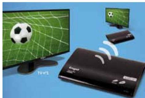
Gracias a sus prestaciones técnicas, resumidas en un alcance real de 30 metros (ampliable a 60m según necesidad de resolución), dos puertos HDMI, resolución de 1080p y su capacidad para transmitir la señal a 5GHz y así evitar interferencias, se convierte en el complemento de televisión idóneo para aquellos usuarios que deseen visualizar los contenidos HD en más de un televisor sin necesidad de cablear de nuevo su local o vivienda.
