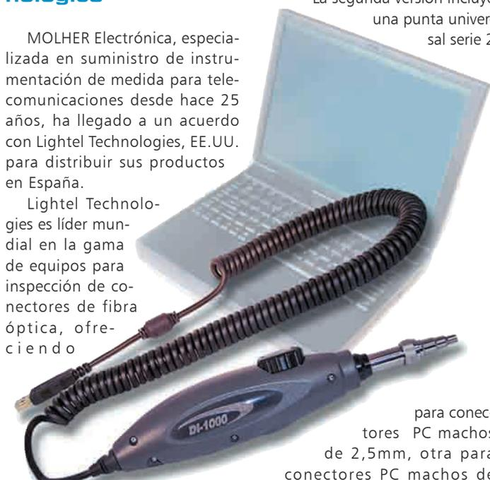
para conectores PC machos de 2,5mm, otra para conectores PC machos de 1,5mm, además una punta serie 2 para conectores tipo SC y FC hembra PC y otra punta para conectores tipo LC hembra PC.
