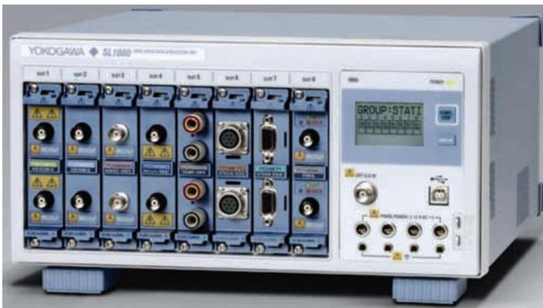
Por ello es necesario utilizar equipos de instrumentación y medida de muy altas prestaciones, que dispongan de aislamiento entre canales, así como gran ancho de banda y rechazo en modo común (CMRR: Common-Mode Rejection Ratio), entre otras prestaciones.
