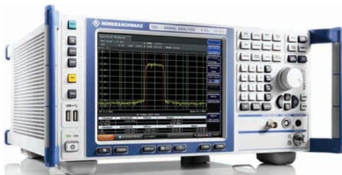
– 1000 medidas/s – lo que significa que el equipo asegura una alta velocidad de transmisión en producción. La pantalla táctil y el teclado integrado en la pantalla facilitan la configuración manual.
