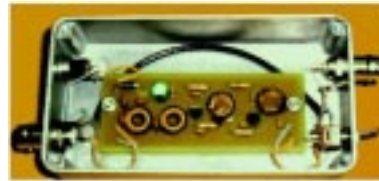
Figura 6 El amplificador montado e instalado con sus conectores y conmutador
