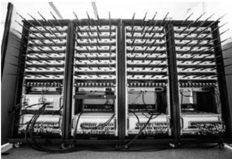
Figura 1. La Universidad de Bristol y la Universidad de Lund implementaron el primer banco de pruebas de massive MIMO en tiempo real y con 128 antenas, que se utilizó para batir dos records mundiales consecutivos en eficiencia espectral inalámbrica.
