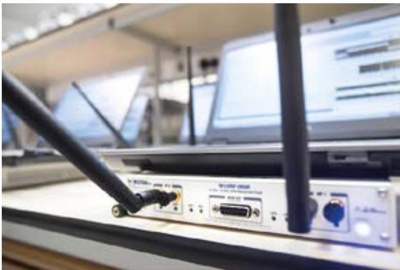
Figura 2. El sistema de creación de prototipos MIMO de NI es modular y se basa en radio definida por software USRP RIO y hardware PXI que permite una amplia gama de configuraciones de antena.
