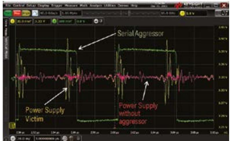
Figura 6. La señal agresora en serie genera el rebote de tierra, que se muestra como picos en la señal víctima de la fuente de alimentación (señal amarilla). Cuando se elimina la señal agresora en serie, los picos desaparecen (señal roja).
