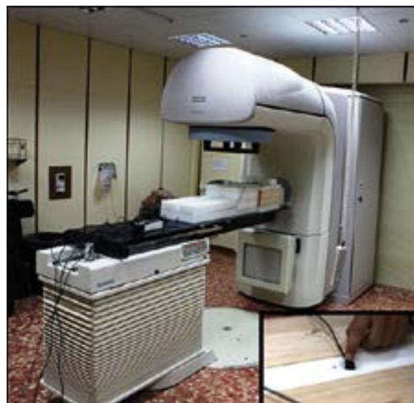
Figura 2. Fantoma antropomórfico y sistema de adquisición de NI sobre la mesa de tratamiento. Detalle de la ubicación del detector de estado sólido sensible a neutrones térmicos colocado en uno de los puntos de medida del fantoma.
