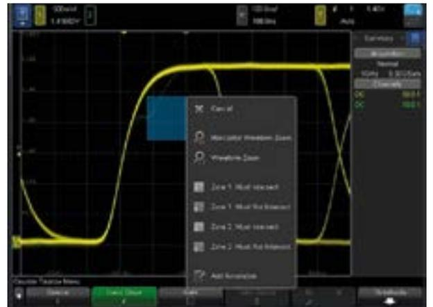
Figura 3. Para aislar una señal con un flanco no monótono, solo hay que trazar un cuadro alrededor de la señal de interés y seleccionar que "debe intersectarse".
