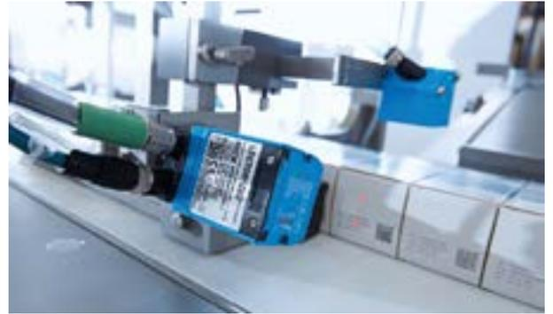
Figura 2. El TriSpector1000 es un método económico de inspección 3D que resulta idóneo para el control de calidad en la industria de los bienes de consumo.
