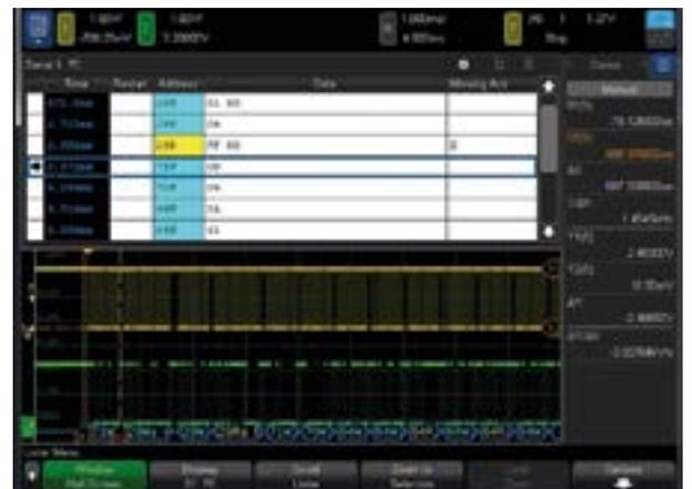
Figura 4. Las herramientas de análisis de protocolos avanzados permiten decodificar comunicaciones serie y analizar eventos. Aquí vemos un recuento de errores CRC en un enlace de comunicación CAN de automoción.
