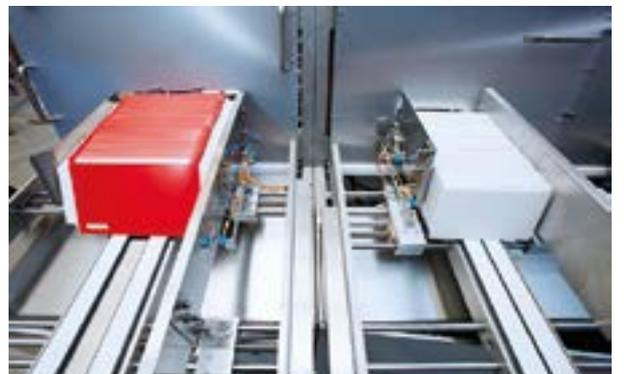
Figura 3. El sensor de patrones PS30 permite gestionar de un modo flexible y sin contratiempos la tendencia de la industria del embalaje a utilizar etiquetas cada vez más elaboradas y originales.
