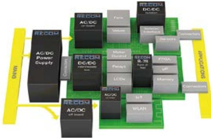
En los modernos circuitos complejos hay una variedad de microcontroladores, circuitos integrados, DSPs, FPGAs y muchos otros componentes que se deben abastecer. Sin embargo, cada uno de estos componentes requiere una tensión de alimentación diferente. Como solución más eficaz para esto, se ha establecido el concepto de suministro de energía distribuido: la combinación de fuente de alimentación "central" y una variedad de módulos de convertidor "locales".
