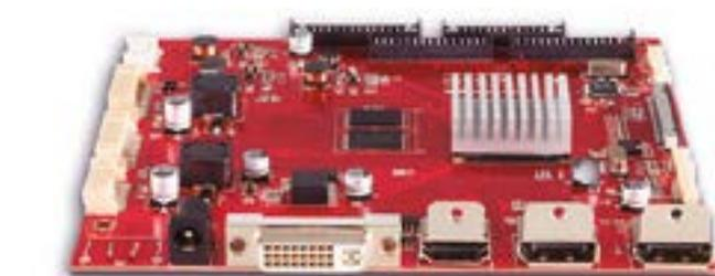
Las nuevas pantallas TFT de alta definición no sólo se controlan mediante LVDS, sino que a menudo tienen dos interfaces diferentes: V-by-One y eDP (Embedded DisplayPort). Dado que aún no se ha determinado qué interfaz prevalecerá, DATA MODUL eMotion UHD ofrece ambas interfaces: Cada uno tiene ocho carriles V-by-One y ocho carriles eDP. Hay varias entradas disponibles para la fuente de señal. Además de la entrada DVI
