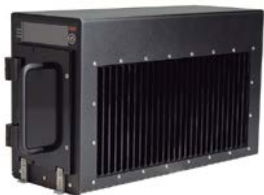
El nuevo servidor MP70 conforme a ARINC 600 se ajusta de MEN, ofrece dos lanzaderas de discos duros de conexión en caliente, que se pueden intercambiar durante el funcionamiento, y dos módems UMTS garantizan el acceso a Internet sin interrupción.
