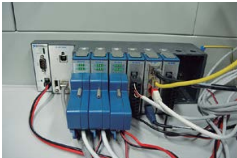
NI cRIO-9066 utilizado para el control de actuadores y lectura de sensores.
