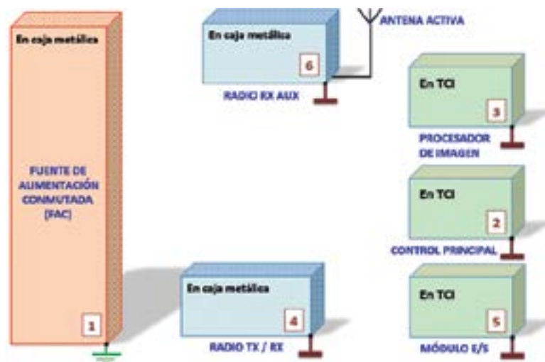
Figura 6. Pasos 1 y 2 – Identificar la arquitectura del sistema y definir las conexiones al chasis a nivel de módulo.
