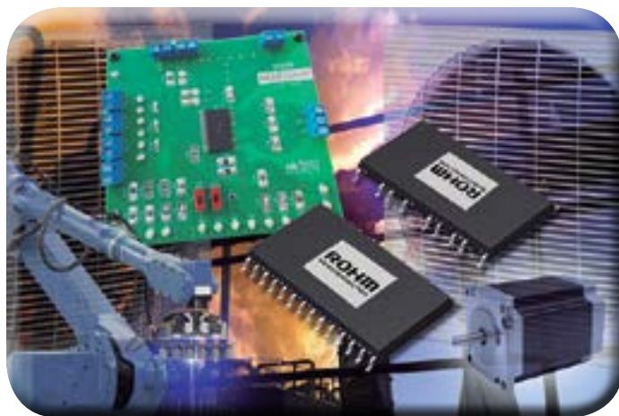
Tarjetas de referencia de ROHM para controladores de motores de ventiladores de alta tensión
