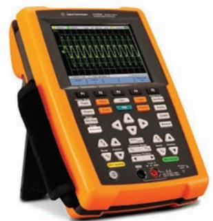
Entre sus funciones de medida destaca una velocidad de muestreo de 1 ó 2 Gmuestras/s y dos canales de entrada con aislamiento de seguridad. Sus funciones de análisis incluyen memoria profunda, ampliación x1.000 y ventanas de zoom dobles para visualización general y detallada.
