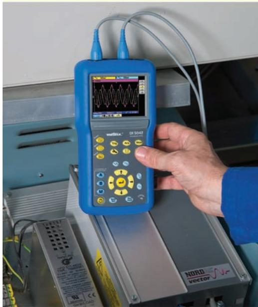
Los nuevos osciloscopios digitales portátiles HANDSCOPE caben perfectamente en una mano y facilitan su trabajo en campo, en especial para realizar medidas en mantenimiento industrial y en instalaciones eléctricas.
