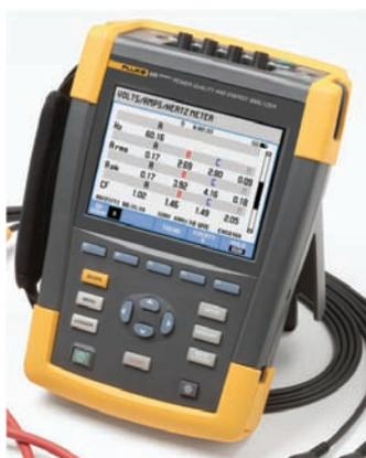
Antes, sólo los expertos podían calcular la cantidad de energía que se estaba perdiendo por problemas relacionados con la calidad eléctrica; con ciertas utilidades se podía calcular el coste ,pero el proceso de medición necesario estaba fuera del alcance del técnico medio. Con la nueva función patentada UPM (Unified Power Measurement, Medida de potencia unificada) del 430
