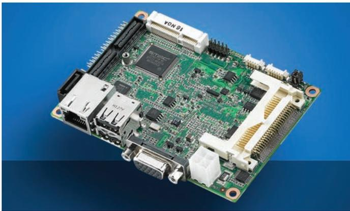
el coste de inversión y el tiempo de desarrollo. Las Pantallas TFT pueden ser controladas por un solo canal de 18 bit LVDS. Tiene una salida VGA y admite configuraciones de doble pantalla.
