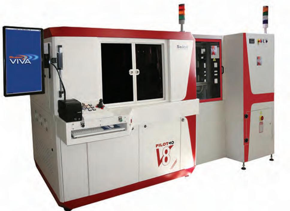
Pilot4DV8 con carga/descarga completamente automática
