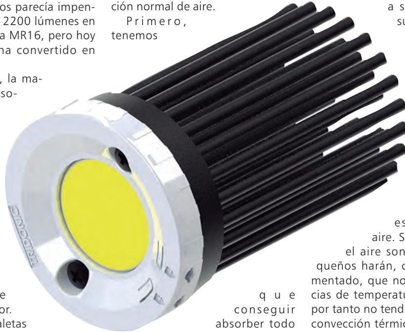
que conseguimos absorber todo el calor de los leds con el disipador. Esto se llama ventilación por conducción. Los parámetros que cuentan en este caso son la superficie de contacto entre el led y el disipador, la conductividad térmica del material utilizado así como el diseño interno del propio disipador. Si las aletas o los pines son demasiado pequeñas o están demasiado próximas unas de otras, la energía térmica experimentará una gran resistencia para repartirse por el volumen del disipador.
