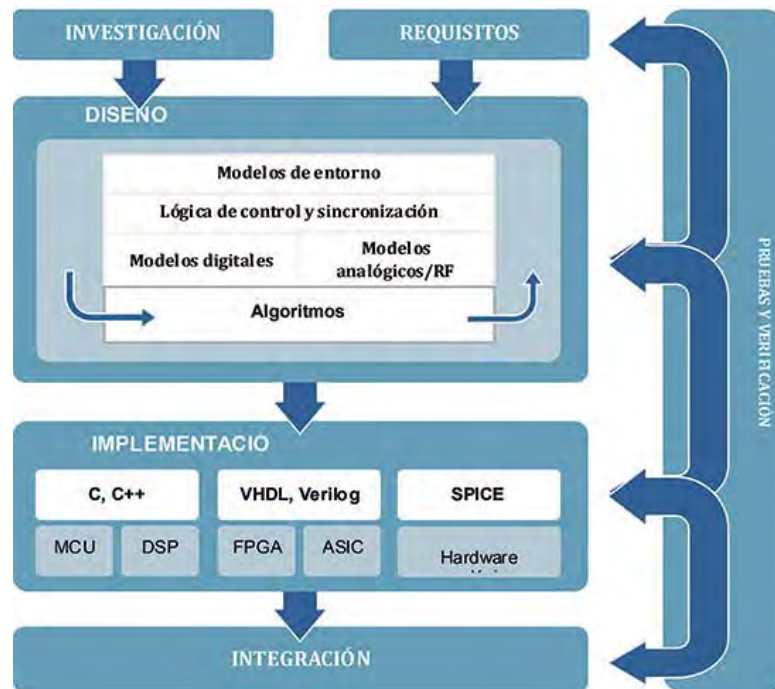
Figura 2. El flujo de trabajo del diseño basado en modelos permite la verificación temprana.
