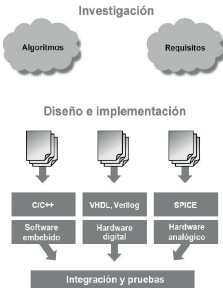
Figura 1. En un flujo típico, los diseños comienzan con los desarrolladores de algoritmos, quienes trasladan el diseño a los equipos de implementación por medio de documentos de especificaciones estáticos.
