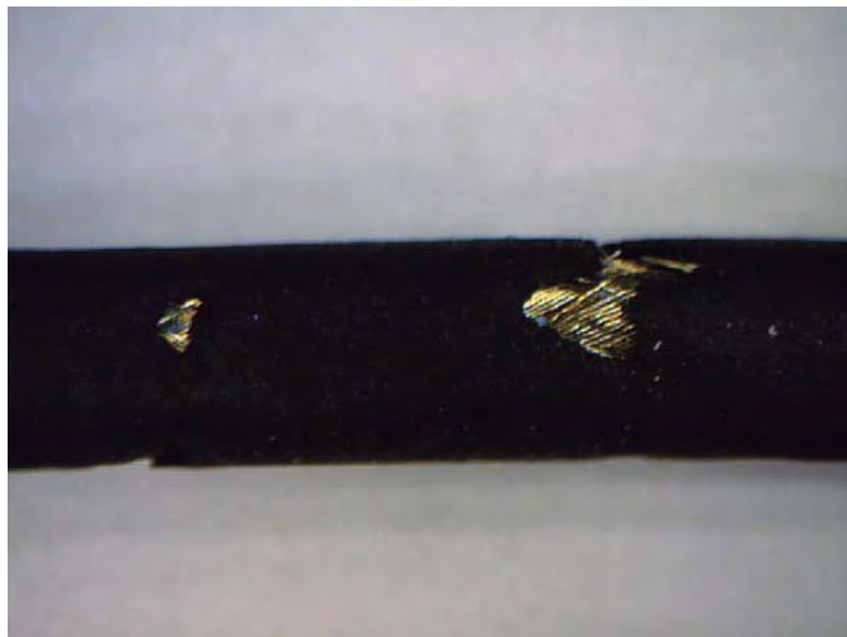
Figura 1 Cable de sonda normal dañado tras una prueba ambiental a 120\text{ }^{\circ}\text{C} .
