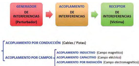
Figura 4: Cualquier problema de CEM tiene uno o varios generadores, uno o varios acoplamientos y uno o varios receptores de interferencias. Entre ellos pueden haber cuatro tipos de acoplamiento.
