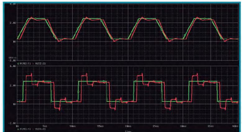
Figura 4: La señal en la carga es más distorsionada (roja abajo) si el tiempo de subida es menor aunque las frecuencias de las dos señales sea la misma (señales verdes)
