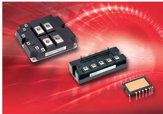
Dependiendo del destino de la aplicación Mitsubishi ofrece estas tres versiones diferentes en tres encapsulados diferentes. Cada nuevo módulo de potencia SiC híbrido está equipado con Si - IGBT y SiC diodos Schottky de barrera (SBD) con el fin de reducir el tamaño, disminuir el peso y aumentar la eficiencia de los convertidores.
