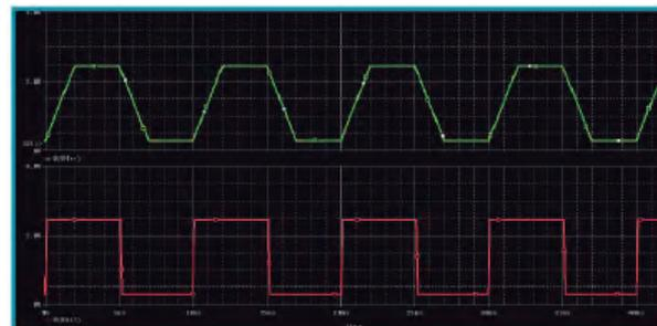
Señales de reloj de 100 MHz con 2 ns y 100 ps de tiempos de conmutación
