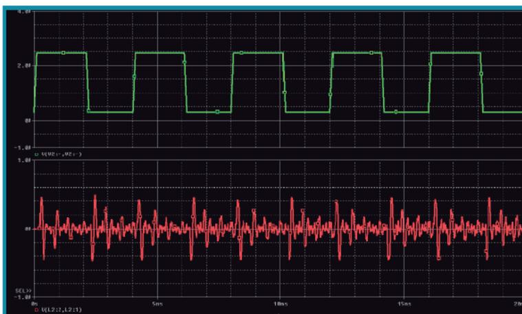
Figura 8: Rebote de masa ("ground bounce"): Ruido de masa debido a la inductancia serie en las conexiones de masa de los circuitos integrados
