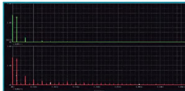
Espectro de frecuencia de las señales de reloj de 100 MHz. La señal de 2 ps tiene armónicos de mayor frecuencia.
