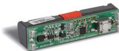
Diseño de referencia con convertidor elevador síncrono MCP1640 (MCP1640RD-4ABC)
