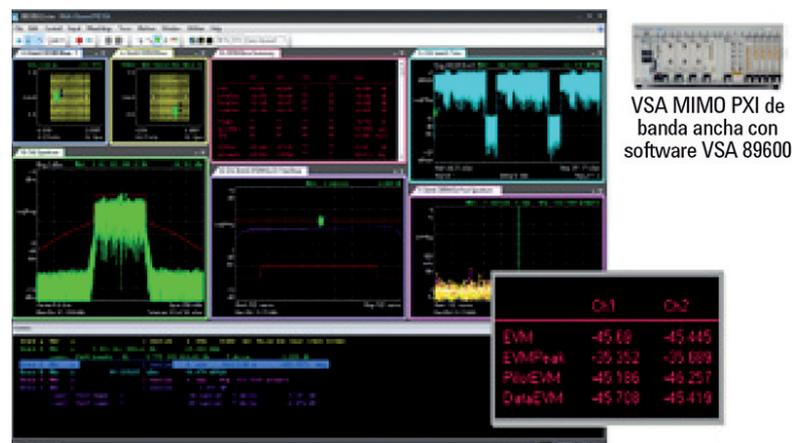
Figura 4. Estos resultados de prueba para una demodulación MIMO 3x3 de 5,8 GHz y 80 MHz indican que el nivel mínimo de la EVM residual del VSA PXI es muy bueno, entre -43 y -46 dB RMS. Aquí, las señales moduladas de RF se introdujeron en tres canales sincronizados del analizador de señales PXI para realizar la medida de MIMO de RF con el software VSA y SystemVue.
