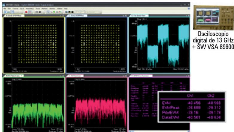
Figura 3. Estos resultados de prueba para una demodulación MIMO 2x2 de 5,8 GHz y 160 MHz muestran las dos constelaciones en la parte superior izquierda y central, los dos espectros centrados a 5,8 GHz en la parte inferior izquierda y central, y la EVM a la derecha.
