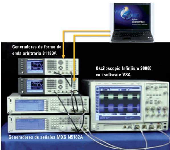
Figura 1. En esta configuración de prueba del hardware MIMO 802.11ac, la fuente de simulación utilizada para diseñar el transmisor de RF también se emplea para descargar formas de onda MIMO en los AWG. El uso de los mismos algoritmos de medida de la EVM en equipos de simulación y prueba es fundamental para minimizar los problemas al pasar de la fase de diseño a la de prueba.
