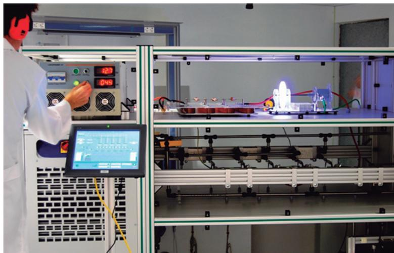
Figura 1 - El prototipo preindustrial para la pasteurización no térmica de leche con el LabVIEW.
