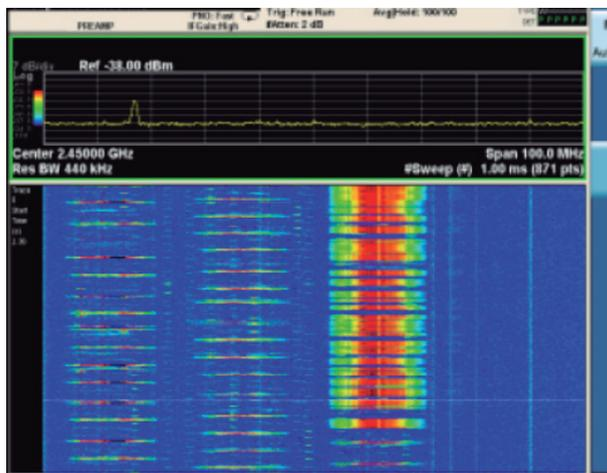
Figura 4: el hecho de seleccionar un tiempo de adquisición de 1 ms en lugar de 30 ms proporciona mayor resolución de tiempo y da más información acerca de la estructura de las ráfagas WLAN y los saltos Bluetooth.
