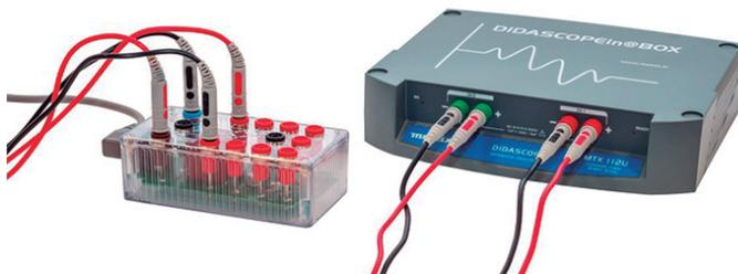
osciloscopio diferencial 10MHz
