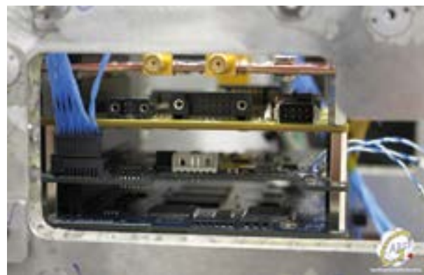
Figura 3. Electrónica de vuelo de UNISAT-7 con la placa GAUSS breakout Board 1 (BOB-1) utilizada para conectar los subsistemas del satélite mediante conectores Harwin.
