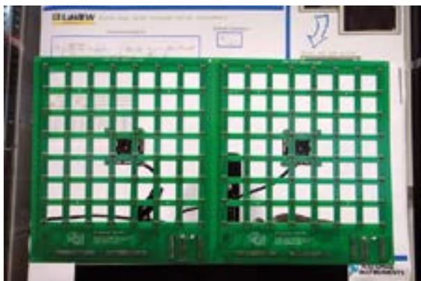
Figura 1. Array de micrófonos MEMS de 128 (16x8) elementos compuesto por dos módulos de 8x8.
