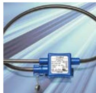
de diámetro para la apertura – la serie ART se puede montar con gran rapidez simplemente abrazando el cable a medir. El contacto con cable no es necesario y la serie ART asegura un alto nivel de protección, además de proporcionar una elevada tensión nominal de aislamiento (1000V Cat III PD2 - reforzado).
