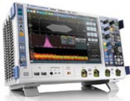
das tales como USB 3.1 Gen 1 con velocidades de datos de 5 Gbit/s. Gracias a su función multidominio, es posible analizar las fuentes de alimentación, procesadores y sensores con ancho de banda de hasta 6 GHz con un único equipo. Los resultados sincronizados del análisis de tiempo, frecuencia, protocolo y lógico permiten a los usuarios depurar a nivel de sistema.
