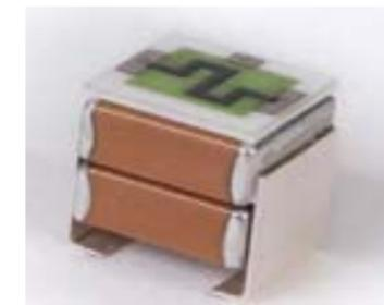
Figura 3. Dispositivo "Smart Cap" que integra una resistencia de drenaje con dos condensadores cerámicos de elevado valor.
