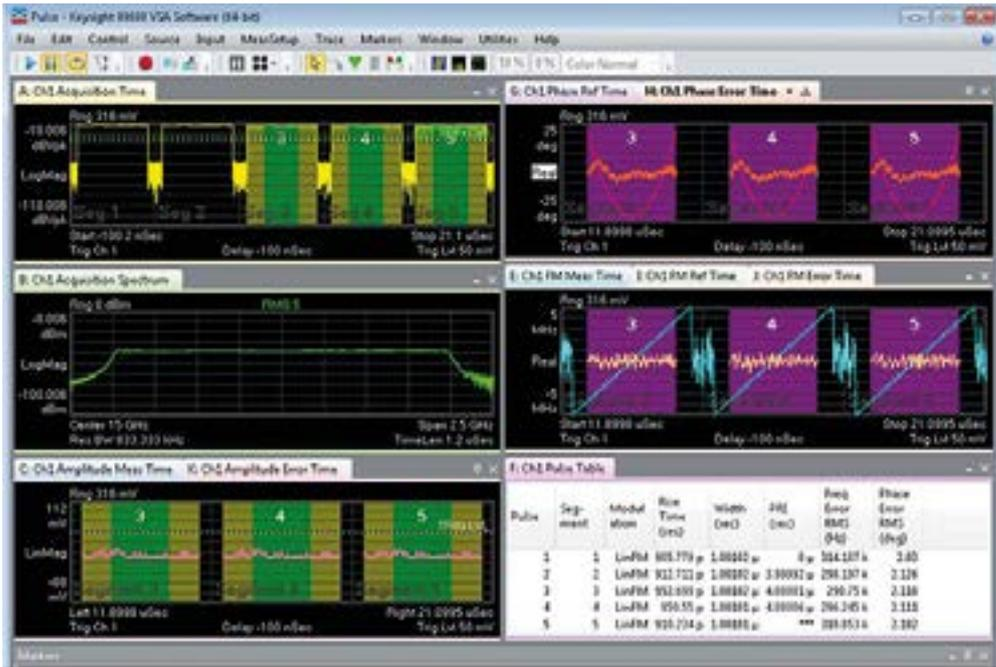
Figura 4. Cálculos de software de análisis de pulsos basados en medidas tomadas en la memoria segmentada de un osciloscopio.
