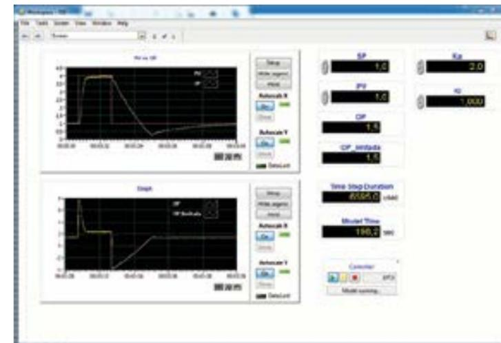
Figura 5. Experimento en lazo cerrado para la configuración HIL #2 (desde la interfaz Veristand)
