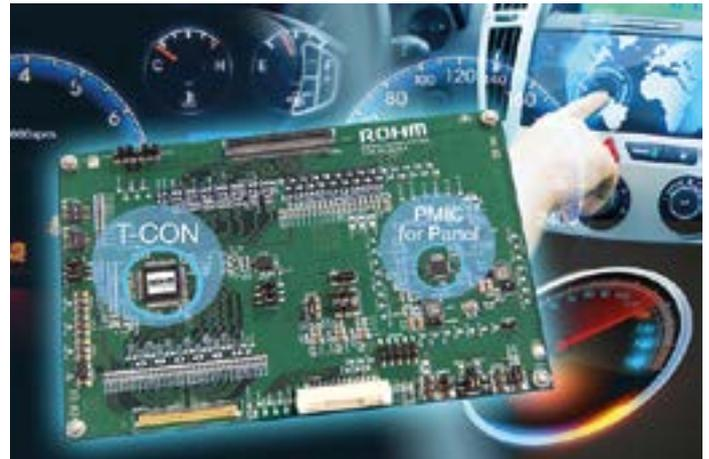
proporcionar información como las señales de entrada al LCD así como el grado de afectación/destrucción del controlador de LCD. La introducción de seguridad funcional ayuda a evitar graves accidentes provocados por el mal funcionamiento de los monitores para el velocímetro, los espejos retrovisores laterales y otros sistemas.
