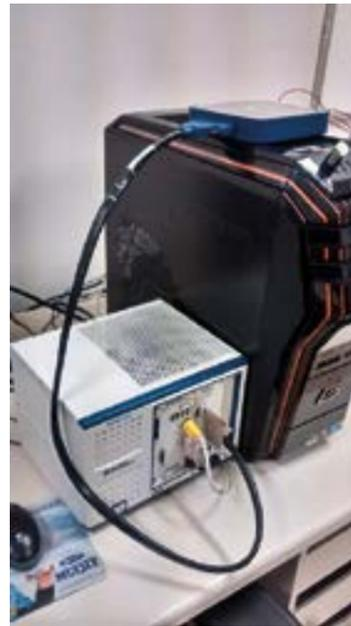
Figura 2. Sistema PXI conectado al PC de desarrollo y al bloque conector de E/S.
