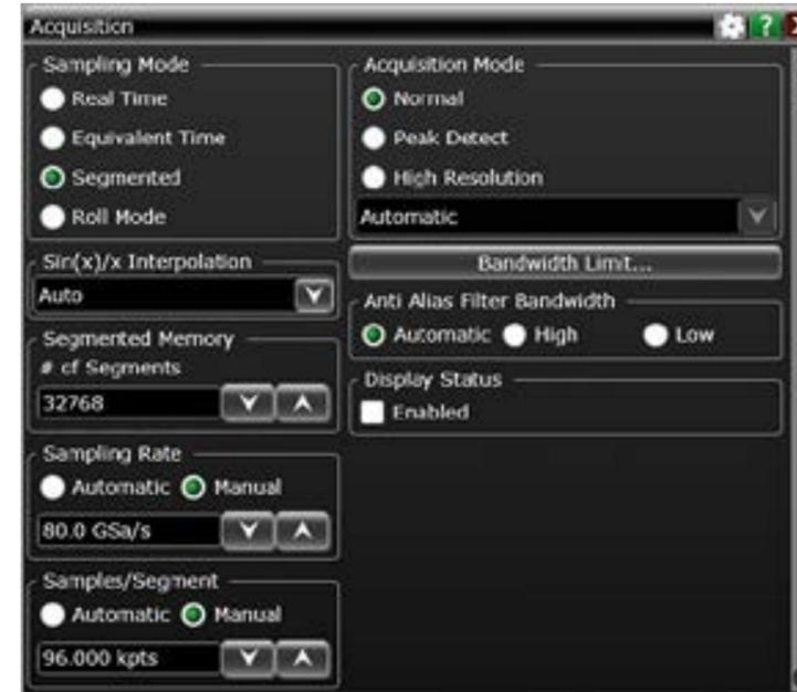
Figura 2. Memoria segmentada configurada para elegir segmentos de 1,2 us de ancho para capturar pulsos de 1 us.
