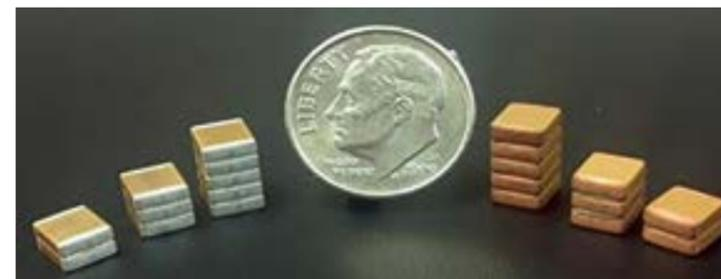
Figura 4. Los condensadores apilados sin la parte conductora interna (leadframe) pesa menos y puede funcionar con temperaturas mucho más altas.
