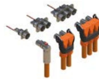
gusta en el sector automovilístico. La conexión sencilla garantiza una protección máxima para el usuario. Si el bloqueo se abre, las altas corrientes se interrumpen de inmediato. La carcasa cumple como mínimo los requisitos de las especificaciones UL94-V-0, RTI130, CT12 y resiste temperaturas de -40 a 125 °C. El revestimiento metálico de 360° garantiza un blindaje completo del conector para IP6K9K en estado conectado y de IP2X en estado desconectado (según DIN 40 050, 9).
