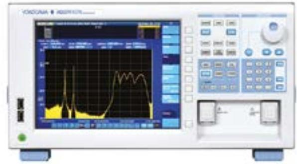
El almacenamiento interno de datos de 512 Mbyte interno, y el almacenamiento de datos externo es soportado a través de una interfaz USB. También se incorporan interfaces Ethernet RJ-45 y GP-IB. Con una fuente de calibración incorporada para una alineación óptica totalmente automática y una calibración de la longitud de onda, en pocos instantes.
