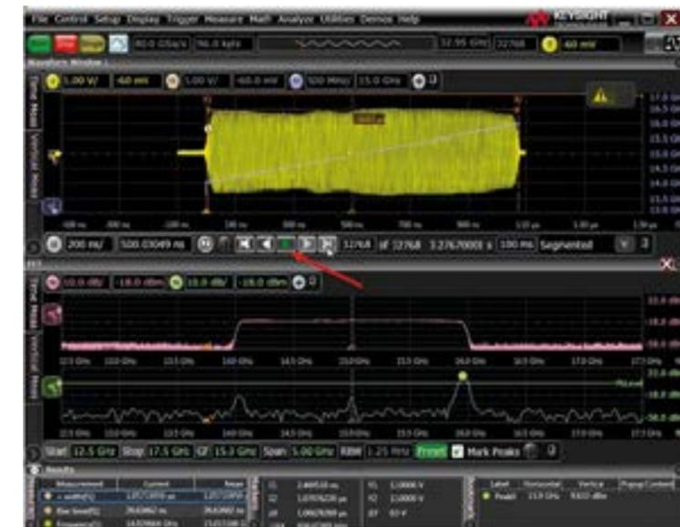
Figura 3. Captura de 32.000 pulsos en 32.000 segmentos, a 1,2 us por segmento, con la memoria segmentada de un osciloscopio de 33 GHz.
