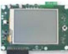
Esta tarjeta de expansión multimedia es una solución integrada y flexible para el desarrollo de interfaces de usuario de gran impacto. La tarjeta se suministra con un visualizador táctil TFT en color de 3,2 pulgadas e interfaces a un kit básico PIC32\* que le permite escoger la familia
