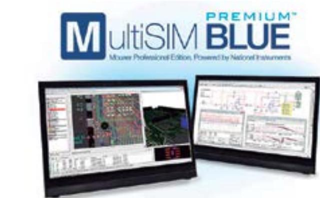
pacidades de anotación hacia adelante o hacia atrás, permitiendo así que los ingenieros transfieran los cambios de un esquema al entorno de trazado de una placa o de un trazado al esquema.
