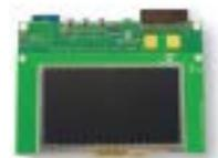
Esta tarjeta es una plataforma de desarrollo de alta integración, compacta y flexible que funciona con los kits básicos PIC32MZ. Este kit incorpora una tarjeta hija con visualizador táctil PCAP WQVGA de 4,3 pulgadas y es compatible con tarjetas de visualización
