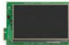
La tarjeta de visualización gráfica Truly de 7 pulgadas y 800 x 480 es una tarjeta de demostración para evaluar la solución de visualización gráfica y la biblioteca gráfica de Microchip para microcontroladores de 16 y 32 bit. Esta tarjeta de expansión
