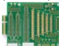
La tarjeta para prototipos de visualización gráfica (juego de tres) ofrece una manera sencilla de integrar una pantalla gráfica LCD que elija en unas de las siguientes plataformas:
