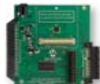
Esta tarjeta permite el desarrollo de soluciones gráficas sin un controlador gráfico externo. La tarjeta está diseñada para conectarse a un kit básico PIC32, a una tarjeta de desarrollo Explorer 16 y a uno los módulos LCD de Microchip.
