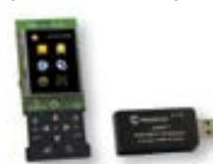
La tarjeta de demostración de control remoto de Microchip integra gráficos, tecnología mTouch®, USB y RF4CE es una sola demostración. Esta tarjeta ofrece la demostración de control remoto con un microcontrolador PIC24FJ256DA210 y un visualizador LCD TFT gráfico de 3,5 pulgadas con pantalla
