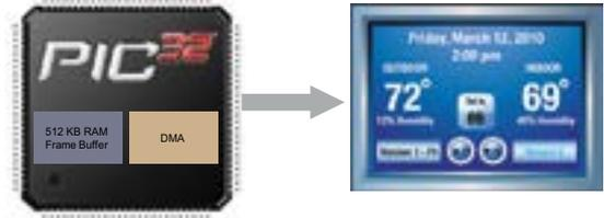
La línea de microcontroladores PIC32 de 32 bit de Microchip ofrece hasta 330 DMIPS y DMA de altas prestaciones para representar gráficos directamente en los visualizadores. Esto permite a los dispositivos PIC32 controlar un visualizador sin un controlador gráfico externo.
