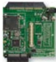
La tarjeta controladora para LCD gráfica PICtail Plus SSD1926 es una tarjeta de demostración para evaluar la solución de visualización gráfica y la biblioteca gráfica de Microchip para microcontroladores de 16 y 32 bit. Se trata de una tarjeta de expansión compatible con la tarjeta de desarrollo Explorer 16 (DM240001) o una
