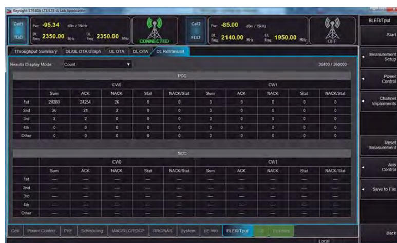
Figura 3.2. Captura de HARQ registrada por el simulador de LTE que muestra la tercera retransmisión durante uno de los barridos.
