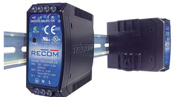
Figura 4. Las nuevas fuentes de alimentación en riel DIN REDIN45 y REDIN60 pueden montarse, junto al montaje tradicional en el lado trasero, en posición lateral, lo cual es ventajoso en armarios de distribución poco profundos.
