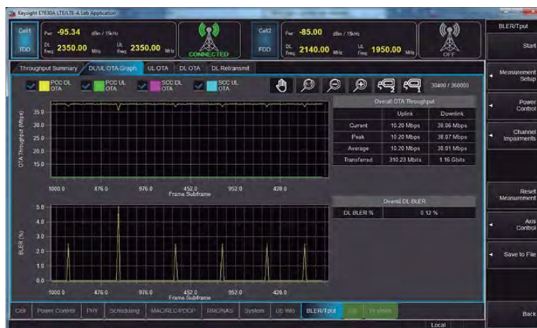
Figura 3.1. Barrido periódico en busca de actividad de redes Wi-Fi por parte de la GUI del UE que da lugar a una BLER considerable.
