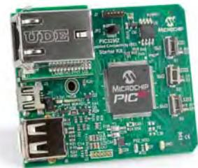
Kit de iniciación PIC32MZ Embedded Connectivity (DM320006 o DM320006-C con motor criptográfico)
