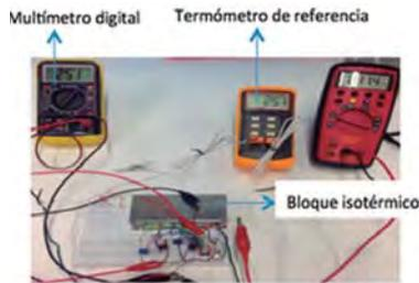
Fig. 8.- Ajuste del termopar a  $T^{\circ}$  ambiente.
