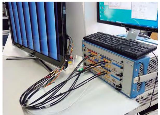
Figura 5. Ejemplo de configuración de una prueba de disipación utilizando un sintetizador de forma de onda arbitraria (AWG).
