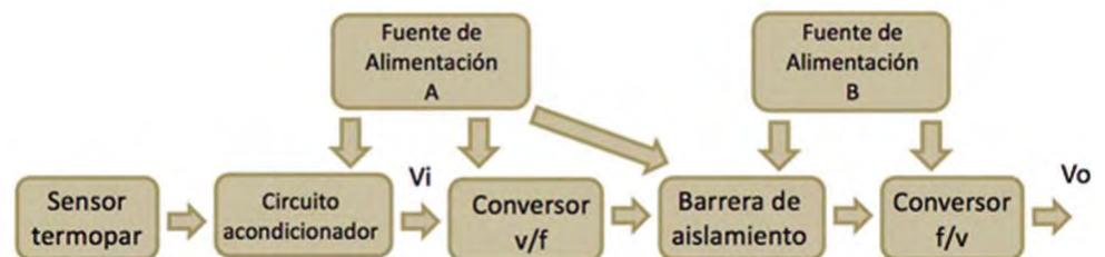
Fig. 5.- Diagrama de bloques del acondicionador electrónico.
