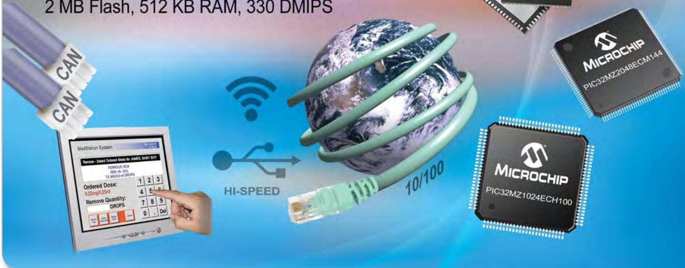
Los nuevos microcontroladores de 32 bit PIC32MZ de Microchip logran unas altas prestaciones junto con un aumento de la densidad de código del 30% y hasta 2 MB de Flash de doble panel con actualización en tiempo real y 512 KB de RAM.
