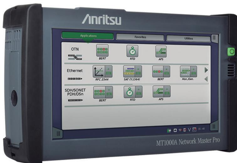
de 9", con indicaciones sencillas y símbolos gráficos de fácil interpretación. La interfaz gráfica de usuario (GUI) permite una fácil configuración y operatividad del equipo, aprovechando todo su potencial. El MT1000A ha sido diseñado utilizando una estructura modular que facilita su escalabilidad, reduciendo los costes iniciales y permitiendo al usuario invertir en distintos niveles de configuración.
