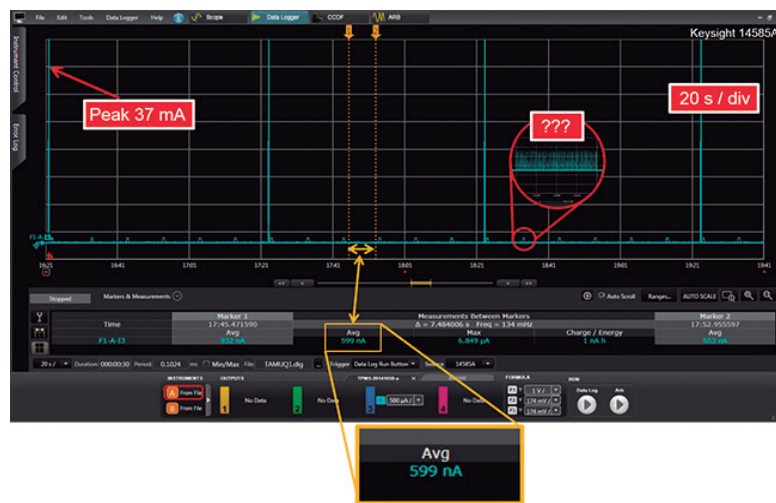
Figura 4. El drenaje de corriente registrado durante 200 segundos de funcionamiento proporciona nueva información sobre el drenaje de corriente dinámica de un dispositivo.
