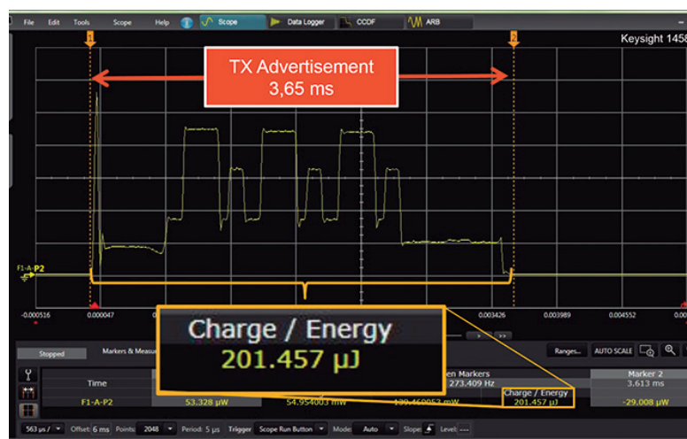
Figura 5. Empleando el software 14585A de Keysight es posible medir la energía directamente en julios.
