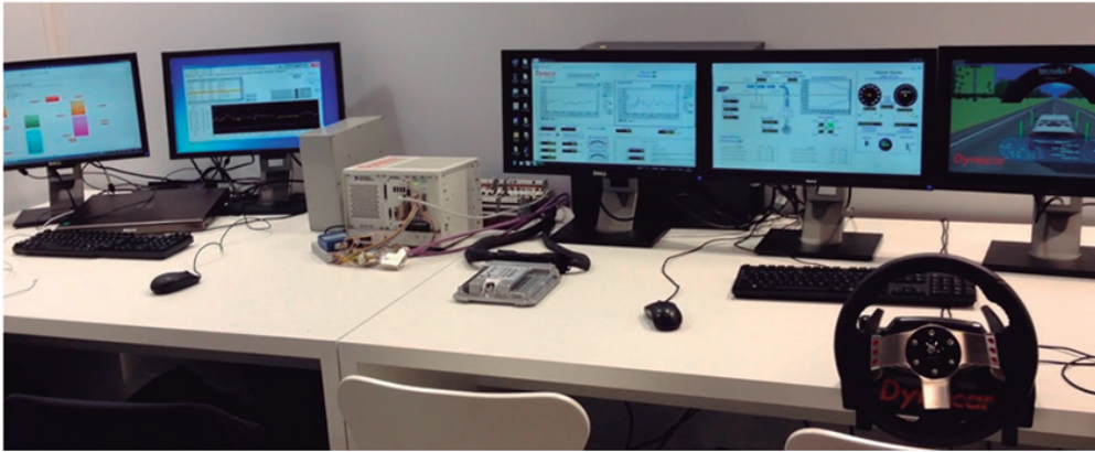
Figura 4. Banco de ensayos con los diferentes componentes. ECU bajo test y PXI de ECUs virtuales.
