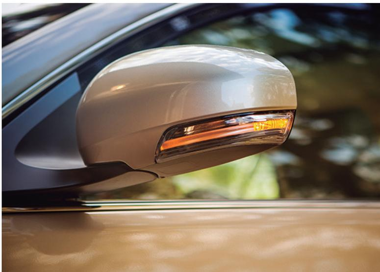
Figura 1. Intermitente LED montado en un espejo para mayor visibilidad.
