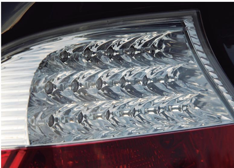
Figura 3. Luz trasera basada en LED, con fuentes de iluminación redundante para mayor fiabilidad.
