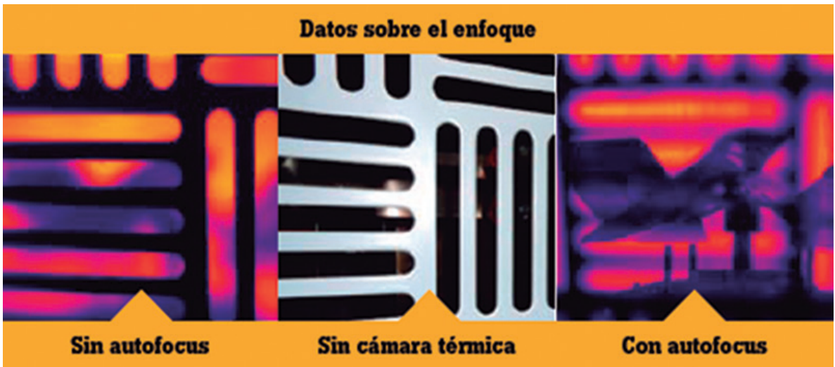
Figura 5. Enfoque en objetos que puede dificultarse con los sistemas tradicionales de autofocus.
