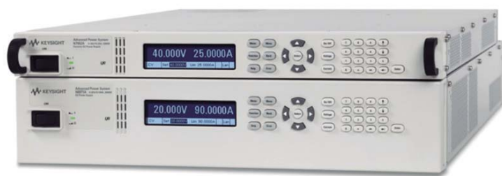
Figura 2. Advanced Power System (APS) de Keysight es una familia de fuentes de alimentación DC con 24 modelos que pueden emular baterías de hasta 160 V y 200 A a 1.000 W y 2.000 W.
