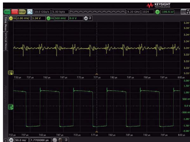
Figura 2. Disparar en el reloj de 10 MHz y habilitar las medias elimina todo el ruido aleatorio y las señales que no son coherentes con el reloj. La vista que se obtiene es la del ruido de la fuente de 3,3 V que está relacionado con el reloj de 10 MHz.
