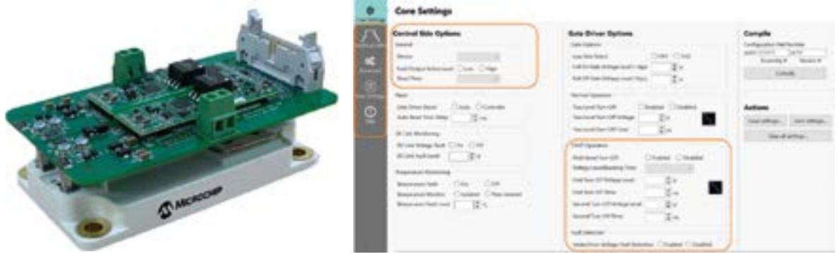
Figura 3. Núcleo del controlador de puerta montado en una placa adaptadora (izquierda) y módulo de potencia de Microchip que representa el kit de evaluación disponible. Captura de pantalla (derecha) que muestra la herramienta de configuración inteligente disponible para la programación de las placas de controladores de puerta.
