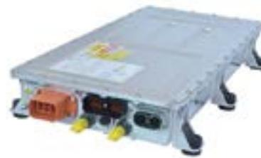
Figura 6. El BCL25-700-8 es un cargador de baterías de 22 kW, con refrigeración líquida, para HEV y EV que se destinan a aplicaciones medianas y pesadas, tanto en carretera como fuera de ella. (Fuente de la imagen: Bel Fuse).
