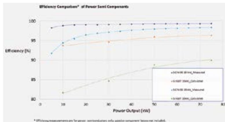
Figura 4. La eficiencia de las soluciones SiC se compara con la de los IGBT de silicio a frecuencias de conmutación de 10 kHz y 30 kHz.
