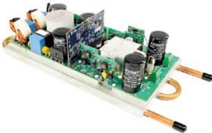
Figura 7. La tarjeta controladora TMDSCNCD28388D (centro) controla el enlace PFC del lado primario (izquierda) y el convertidor CLLC de puente completo del lado secundario con rectificación sincrónica (derecha). (Fuente de la imagen: Texas Instruments).
