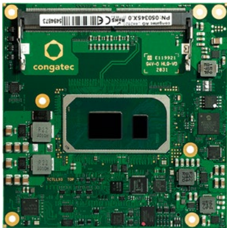
Figura 4. El módulo COM Express Compact del conga-TC570 con procesador Intel Tiger Lake UP3 puede ser montado plug & play en placas base existentes COM Express - independientemente de si están diseñadas para COM Express Basic o Compact. Por lo tanto, están listos para su uso inmediato.
