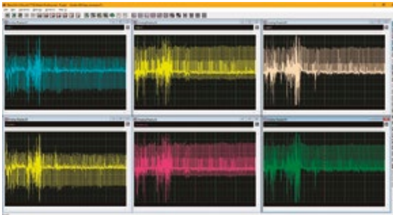
Figura 4. Ejemplo de estrategia de prueba de registro y reproducción mediante un registrador de electrocardiograma Holter de tres cables. Los tres gráficos superiores se adquieren en los cables 1 a 3. Las señales se copian y reproducen como canales del generador de ondas arbitrarias.
