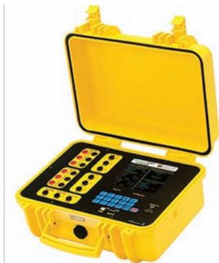
El Greentest FTV100 calcula el rendimiento de los paneles fotovoltaicos incorporando las medidas de irradiación solar, temperatura ambiente, y temperatura del panel, a los valores de corriente y tensión de salida del panel. Al mismo tiempo o a posteriori, el Greentest calcula la eficiencia de la conversión DC/AC a la salida del inversor, midiendo las tensiones y corrientes aguas arriba y abajo del mismo.
