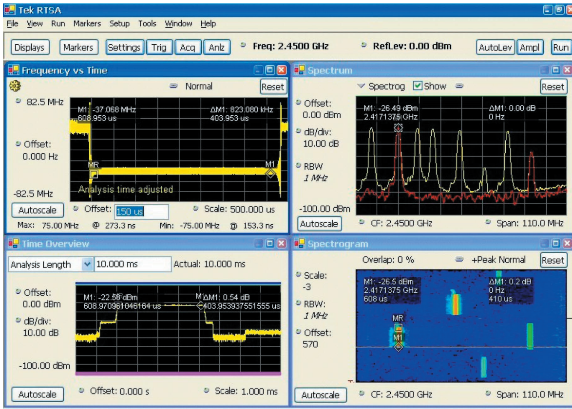
Figura 3. Secuencia de saltos de frecuencia de la señal de Bluetooth, incluyendo (en sentido horario desde la parte superior izquierda) la frecuencia con respecto al tiempo, el espectro con una traza en rojo del espectrograma correspondiente a un determinado momento en el tiempo, una panorámica general de la potencia con respecto al tiempo y el espectrograma de 110MHz cubriendo la secuencia de saltos de frecuencia.
