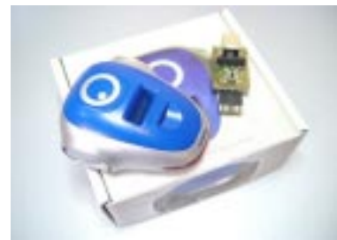
Figura 5. El Moway con la tarjeta de adaptación USB al PC que le permite la grabación de los programas de aplicación.
